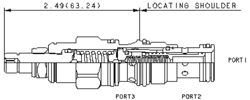
Les distributeurs en cartouches normalement fermés à action pilotée, à 2 voies, sont des dispositifs de commutation utilisés dans des circuits au débit modéré. Ils peuvent être utilisés tels quels ou pour activer des distributeurs pilotés ou des cartouches logiques de taille supérieure. La valve commute quand la différence de pression entre les chambres 1 et 3 dépasse le tarage.
