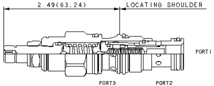
3/2-Wegeventil, vorgesteuert, in Ruhestellung Anschluss 1 verschlossen und Anschluss 2 mit 3 verbunden, für Schaltkreise mit kleinen Volumenströmen. Das Ventil kann den Ölstrom direkt steuern oder als Vorsteuerventil eine Hauptstufe betätigen. Es schaltet, sobald die Druckdifferenz zwischen Anschluss 1 und 3 größer ist als der Einstellwert.
