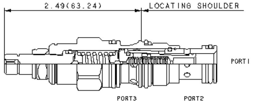
Les distributeurs en cartouches à action pilotée, à 3 voies (1 bloqué et 2 vers 3 passant) sont des dispositifs de commutation utilisés dans des circuits au débit modéré. Ils peuvent être utilisés tels quels ou pour activer des distributeurs pilotés ou des cartouches logiques de taille supérieure. La valve commute quand la différence de pression entre les chambres 1 et 3 dépasse le tarage.
