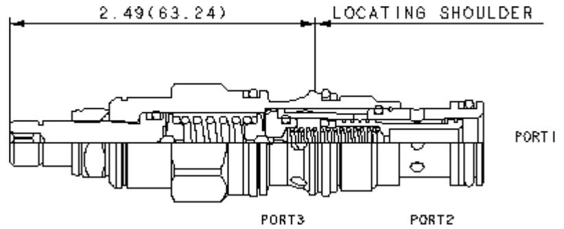
3/2-Wegeventile, vorgesteuert, in Ruhestellung Anschluss 1 mit 2 verbunden und Anschluss 3 verschlossen, für Schaltkreise mit kleinen Volumenströmen. Das Ventil kann den Ölstrom direkt steuern oder als Vorsteuerventil eine Hauptstufe betätigen. Es schaltet, sobald die Druckdifferenz zwischen Anschluss 1 und 3 größer ist als der Einstellwert.
