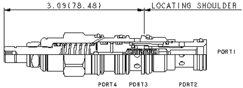
2/2-Wegeventil, vorgesteuert, mit geöffneter Ausgangsstellung, für Schaltkreise mit kleinen Volumenströmen. Das Ventil kann den Ölstrom direkt steuern oder als Vorsteuerventil eine Hauptstufe betätigen. Es schaltet, sobald die Druckdifferenz zwischen Anschluss 1 und 4 größer ist als der Einstellwert.
