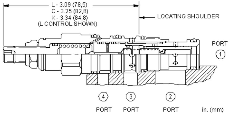
2/2-Wegeventil, vorgesteuert, mit geöffneter Ausgangsstellung, für Schaltkreise mit kleinen Volumenströmen. Das Ventil kann den Ölstrom direkt steuern oder als Vorsteuerventil eine Hauptstufe betätigen. Es schaltet, sobald die Druckdifferenz zwischen Anschluss 1 und 4 größer ist als der Einstellwert.
