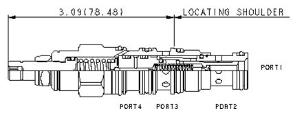
Les distributeurs en cartouches normalement fermés à action pilotée, à 2 voies sont des dispositifs de commutation utilisés dans des circuits au débit modéré. Ils peuvent être utilisés tels quels ou pour activer des distributeurs pilotés de taille supérieure ou des cartouches logiques. La valve commute quand la différence de pression entre les chambres 1 et 4 dépasse le tarage.
