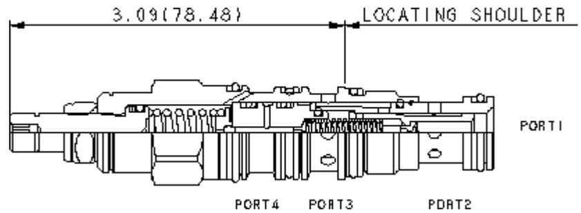
Les distributeurs en cartouches normalement fermés à action pilotée, à 2 voies sont des dispositifs de commutation utilisés dans des circuits au débit modéré. Ils peuvent être utilisés tels quels ou pour activer des distributeurs pilotés de taille supérieure ou des cartouches logiques. La valve commute quand la différence de pression entre les chambres 1 et 4 dépasse le tarage.
