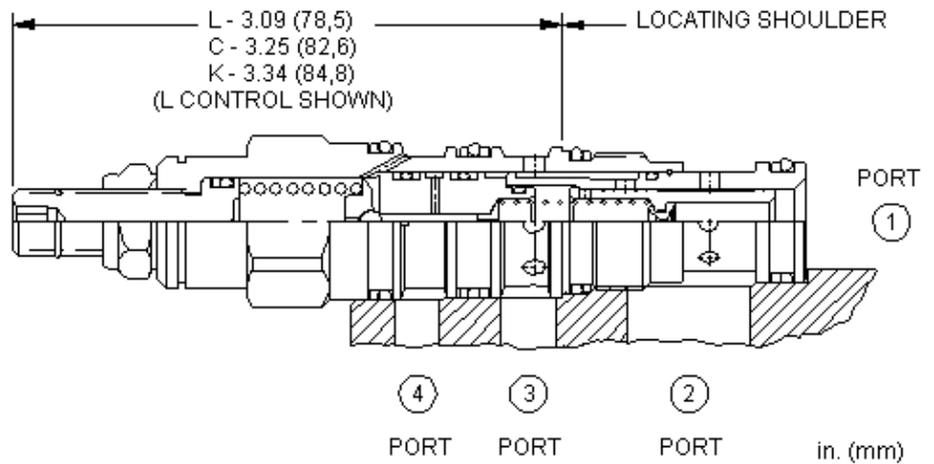
2/2-Wegeventil, vorgesteuert, mit geschlossener Ruhestellung für Schaltkreise mit kleinen Volumenströmen. Das Ventil kann den Ölstrom direkt steuern oder als Vorsteuerventil eine Hauptstufe betätigen. Es schaltet, sobald die Druckdifferenz zwischen Anschluss 1 und 4 größer ist als der Einstellwert.
