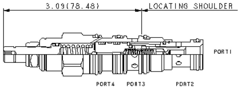
3/2-Wegeventil, vorgesteuert, in Ruhestellung Anschluss 1 geschlossen und Anschluss 2 mit 3 verbunden, für Schaltkreise mit kleinen Volumenströmen. Das Ventil kann den Ölstrom direkt steuern oder als Vorsteuerventil eine Hauptstufe betätigen. Es schaltet, sobald die Druckdifferenz zwischen Anschluss 1 und 4 größer ist als der Einstellwert.
