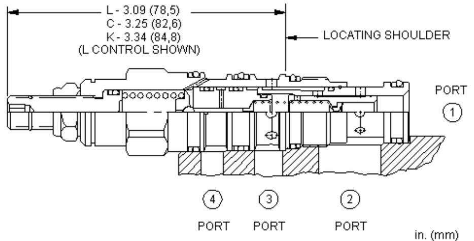
3/2-Wegeventil, vorgesteuert, in Ruhestellung Anschluss 1 geschlossen und Anschluss 2 mit 3 verbunden, für Schaltkreise mit kleinen Volumenströmen. Das Ventil kann den Ölstrom direkt steuern oder als Vorsteuerventil eine Hauptstufe betätigen. Es schaltet, sobald die Druckdifferenz zwischen Anschluss 1 und 4 größer ist als der Einstellwert.
