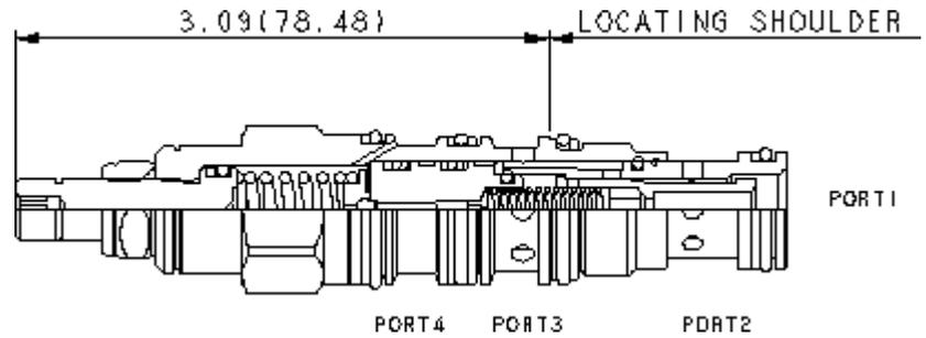
Les distributeurs en cartouches à action pilotée, à 3 voies (1 vers 2 passant et 3 bloqué) sont des dispositifs de commutation utilisés dans des circuits au débit modéré. Ils peuvent être utilisés tels quels ou pour activer des distributeurs pilotés de taille supérieure ou des cartouches logiques. La valve commute quand la différence de pression entre les chambres 1 et 4 dépasse le tarage.
