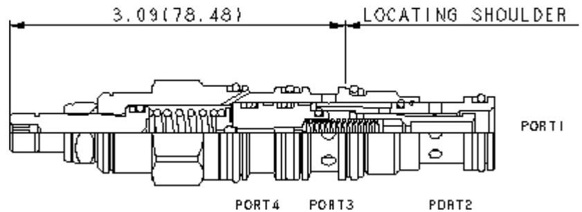
3/2-Wegeventil, vorgesteuert, in Ruhestellung Anschluss 1 mit 2 verbunden und Anschluss 3 verschlossen, für Schaltkreise mit kleinen Volumenströmen. Das Ventil kann den Ölstrom direkt steuern oder als Vorsteuerventil eine Hauptstufe betätigen. Es schaltet, sobald die Druckdifferenz zwischen Anschluss 1 und 4 größer ist als der Einstellwert.
