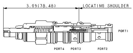
Les distributeurs en cartouches à action pilotée, à 3 voies (1 vers 2 passant et 3 bloqué) sont des dispositifs de commutation utilisés dans des circuits au débit modéré. Ils peuvent être utilisés tels quels ou pour activer des distributeurs pilotés de taille supérieure ou des cartouches logiques. La valve commute quand la différence de pression entre les chambres 1 et 4 dépasse le tarage.
