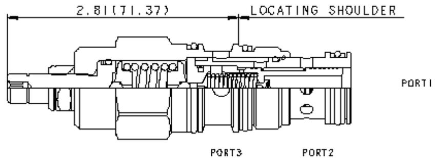
2/2-Wegeventil, vorgesteuert, mit geöffneter Ruhestellung für Schaltkreise mit kleinen Volumenströmen. Das Ventil kann den Ölstrom direkt steuern oder als Vorsteuerventil eine Hauptstufe betätigen. Es schaltet, sobald die Druckdifferenz zwischen Anschluss 1 und 3 größer ist als der Einstellwert.
