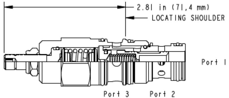
Les distributeurs en cartouches à action pilotée, à 3 voies (1 bloqué et 2 vers 3 passant) sont des dispositifs de commutation utilisés dans des circuits au débit modéré. Ils peuvent être utilisés tels quels ou pour activer des distributeurs pilotés ou des cartouches logiques de taille supérieure. La valve commute quand la différence de pression entre les chambres 1 et 3 dépasse le tarage.
