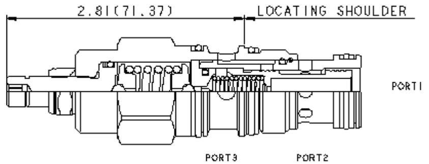
3/2-Wegeventile, vorgesteuert, in Ruhestellung Anschluss 1 mit 2 verbunden und Anschluss 3 verschlossen, für Schaltkreise mit kleinen Volumenströmen. Das Ventil kann den Östrom direkt steuern oder als Vorsteuerventil eine Hauptstufe betätigen. Es schaltet, sobald die Druckdifferenz zwischen Anschluss 1 und 3 größer ist als der Einstellwert.
