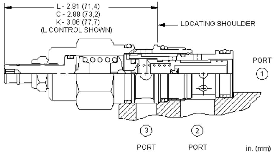
3/2-Wegeventile, vorgesteuert, in Ruhestellung Anschluss 1 mit 2 verbunden und Anschluss 3 verschlossen, für Schaltkreise mit kleinen Volumenströmen. Das Ventil kann den Ölstrom direkt steuern oder als Vorsteuerventil eine Hauptstufe betätigen. Es schaltet, sobald die Druckdifferenz zwischen Anschluss 1 und 3 größer ist als der Einstellwert.
