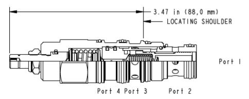
Les distributeurs en cartouches normalement ouverts à action pilotée, à 2 voies sont des dispositifs de commutation utilisés dans des circuits au débit modéré. Ils peuvent être utilisés tels quels ou pour activer des
