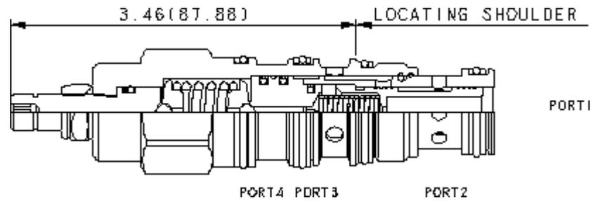
2/2-Wegeventil, vorgesteuert, mit geschlossener Ruhestellung für Schaltkreise mit kleinen Volumenströmen. Das Ventil kann den Ölstrom direkt steuern oder als Vorsteuerventil eine Hauptstufe betätigen. Es schaltet, sobald die Druckdifferenz zwischen Anschluss 1 und 4 größer ist als der Einstellwert.
