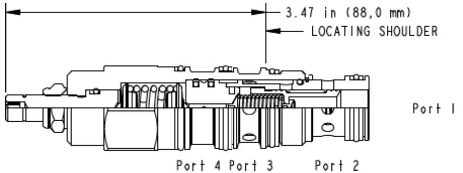
Les distributeurs en cartouches à action pilotée, à 3 voies (1 bloqué et 2 vers 3 passant) sont des dispositifs de commutation typiquement utilisés dans des circuits au débit modéré. Ils peuvent être utilisés tels quels ou pour activer des distributeurs pilotés ou des cartouches logiques. La valve commute quand la différence de pression entre les chambres 1 et 4 dépasse le tarage.
