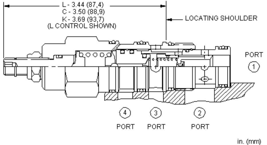
3/2-Wegeventil, vorgesteuert, in Ruhestellung Anschluss 1 geschlossen und Anschluss 2 mit 3 verbunden, für Schaltkreise mit kleinen Volumenströmen. Das Ventil kann den Ölstrom direkt steuern oder als Vorsteuerventil eine Hauptstufe betätigen. Es schaltet, sobald die Druckdifferenz zwischen Anschluss 1 und 4 größer ist als der Einstellwert.
