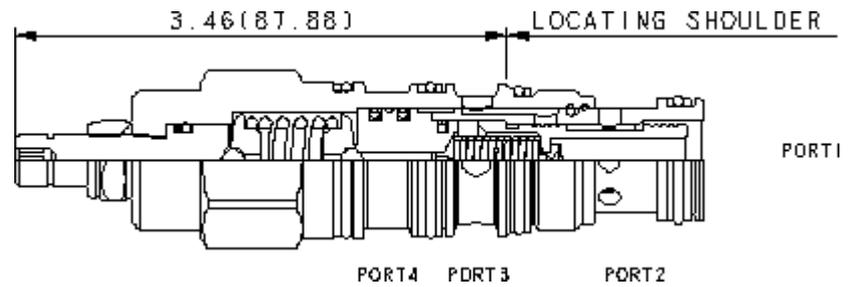
Les distributeurs en cartouches à action pilotée, à 3 voies (1 vers 2 passant et 3 bloqué) sont des dispositifs de commutation utilisés dans des circuits au débit modéré. Ils peuvent être utilisés tels quels ou pour activer des distributeurs pilotés de taille supérieure ou des cartouches logiques. La valve commute quand la différence de pression entre les chambres 1 et 4 dépasse le tarage.
