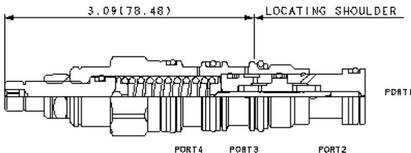
La cartouche directionnelle à 2 voies à action directe normalement fermée avec drain externe est une valve pilote de décharge qui, réagissant à la pression d'une ligne permet de commuter ou décharger une valve dans une autre ligne. Quand la pression dans la chambre 1 dépasse le tarage de la valve, le tiroir commute pour relier la chambre 2 à la 3.
