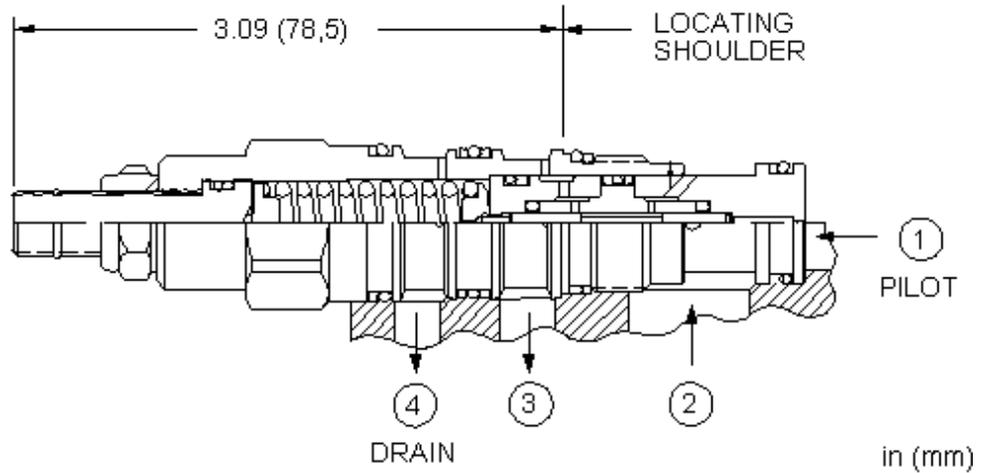
Das in der Ruhestellung geschlossene, direkt betätigte 2/2-Wegeventil mit externer Entlastung überwacht den Druck in einem Kreis, um ein Ventil in einem anderen Kreis zu schalten oder zu entlasten. Wenn der Druck am Anschluss 1 den Ventileinstellwert übersteigt, dann schaltet der Kolben und verbindet den Anschluss 2 mit 3.
