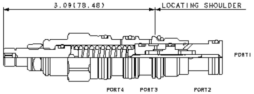
La cartouche directionnelle à 2 voies à action directe normalement ouverte avec drain externe est une valve pilote de décharge qui, réagissant à la pression d'une ligne permet de commuter ou décharger une valve dans une autre ligne. Quand la pression dans la chambre 1 dépasse le tarage de la valve, le tiroir commute pour isoler la chambre 2 de la 3.
