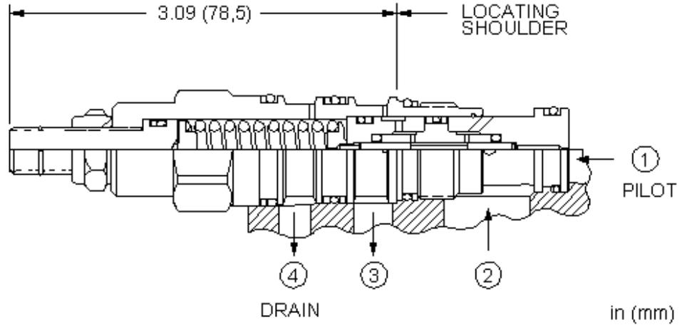
Das in der Ruhestellung geöffnete, direkt betätigte 2/2-Wegeventil mit externer Entlastung überwacht den Druck in einem Kreis, um ein Ventil in einem anderen Kreis zu schalten oder zu entlasten. Wenn der Druck am Anschluss 1 den Ventileinstellwert übersteigt, dann schaltet der Kolben und sperrt die Verbindung von 2 nach 3.
