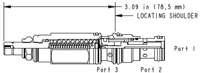
2/2-Wegeventil, direkt betätigt, mit geöffneter Ausgangsstellung, für Schaltkreise mit kleinen Volumenströmen. Das Ventil kann den Ölstrom direkt steuern oder als Vorsteuerventil eine Hauptstufe betätigen. Es schaltet, sobald die Druckdifferenz zwischen Anschluss 1 und 3 größer ist als der Einstellwert.
