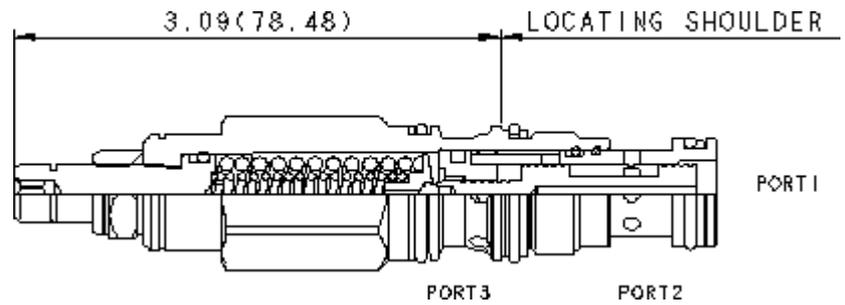
Les distributeurs en cartouches normalement fermés à action directe, à 2 voies, sont des dispositifs de commutation utilisés dans des circuits au débit modéré. Ils peuvent être utilisés tels quels ou pour activer des distributeurs pilotés ou des cartouches logiques de taille supérieure. La valve commute quand la différence de pression entre les chambres 1 et 3 dépasse le tarage.
