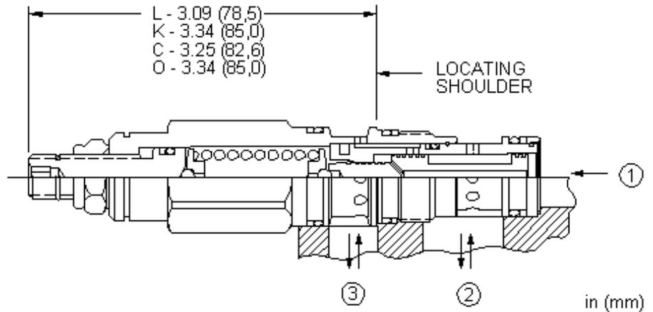
Les distributeurs en cartouches à action directe, à 3 voies (1 vers 2 passant et 3 bloqué) sont des dispositifs de commutation utilisés dans des circuits au débit modéré. Ils peuvent être utilisés tels quels ou pour activer des distributeurs pilotés ou des cartouches logiques de taille supérieure. La valve commute quand la différence de pression entre les chambres 1 et 3 dépasse le tarage.
