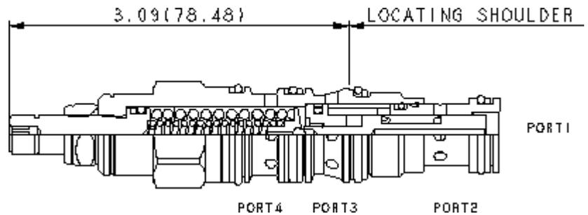
2/2-Wegeventil, direkt betätigt, mit geöffneter Ausgangsstellung, für Schaltkreise mit kleinen Volumenströmen. Das Ventil kann den Ölstrom direkt steuern oder als Vorsteuerventil eine Hauptstufe betätigen. Es schaltet, sobald die Druckdifferenz zwischen Anschluss 1 und 4 größer ist als der Einstellwert.
