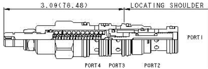
2/2-Wegeventil, direkt betätigt, mit geöffneter Ausgangsstellung, für Schaltkreise mit kleinen Volumenströmen. Das Ventil kann den Ölstrom direkt steuern oder als Vorsteuerventil eine Hauptstufe betätigen. Es schaltet, sobald die Druckdifferenz zwischen Anschluss 1 und 4 größer ist als der Einstellwert.
