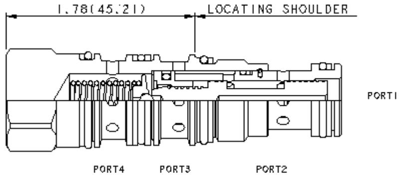
Les cartouches de distribution normalement ouvertes à action directe, à 2 voies, sont des dispositifs de commutation utilisés dans des circuits au débit modéré. Ils peuvent être utilisés tels quels ou pour activer des distributeurs pilotés ou des cartouches logiques de taille supérieure. La valve commute quand la différence de pression entre les chambres 1 et 4 dépasse le tarage.
