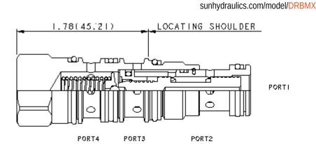
2/2-Wegeventil, direkt betätigt, mit geöffneter Ausgangsstellung, für Schaltkreise mit kleinen Volumenströmen. Das Ventil kann den Ölstrom direkt steuern oder als Vorsteuerventil eine Hauptstufe betätigen. Es schaltet, sobald die Druckdifferenz zwischen Anschluss 1 und 4 größer ist als der Einstellwert.
