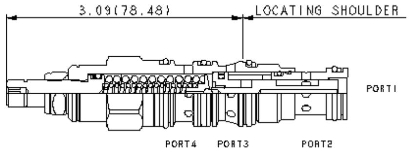
Les distributeurs en cartouches normalement fermés à action directe, à 3 voies, sont des dispositifs de commutation utilisés dans des circuits au débit modéré. Ils peuvent être utilisés tels quels ou pour activer des distributeurs pilotés ou des cartouches logiques de taille supérieure. La valve commute quand la différence de pression entre les chambres 1 et 4 dépasse le tarage.
