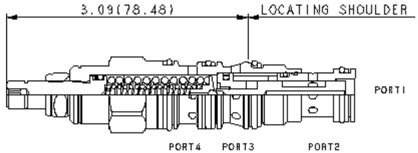
常闭, 直动式, 2通换向阀为切换装置, 常用在中等流量油路中。它们可以单独使用或者用来驱动更大流量的先导控制换向阀或者逻辑阀。当口1与口4之间的压差超出设定时, 此阀将切换。
