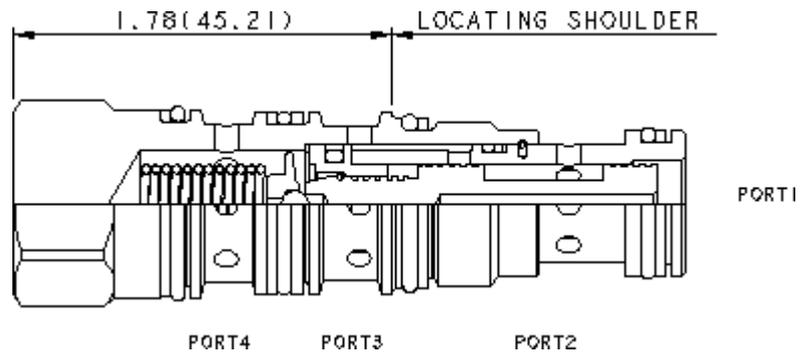
2/2-Wegeventil, direkt betätigt, mit geschlossener Ausgangsstellung, für Schaltkreise mit kleinen Volumenströmen. Das Ventil kann den Ölstrom direkt steuern oder als Vorsteuerventil eine Hauptstufe betätigen. Es schaltet, sobald die Druckdifferenz zwischen Anschluss 1 und 4 größer ist als der Einstellwert.
