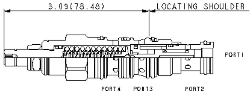
3/2-Wegeventil, direkt betätigt, in Ruhestellung Anschluss 1 verschlossen und Anschluss 2 mit 3 verbunden, für Schaltkreise mit kleinen Volumenströmen. Das Ventil kann den Ölstrom direkt steuern oder als Vorsteuerventil eine Hauptstufe betätigen. Es schaltet, sobald die Druckdifferenz zwischen Anschluss 1 und 4 größer ist als der Einstellwert.
