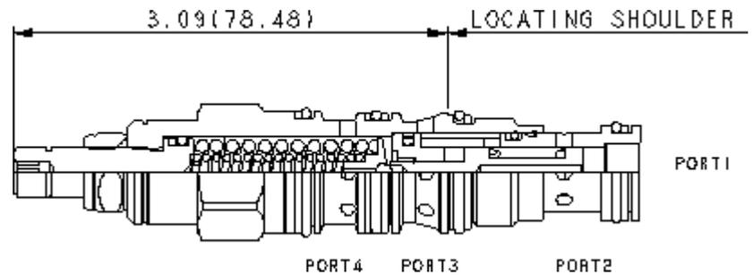
Les distributeurs en cartouches à action directe, à 3 voies (1 bloqué et 2 vers 3 passant) sont des dispositifs de commutation utilisés dans des circuits au débit modéré. Ils peuvent être utilisés tels quels ou pour activer des distributeurs pilotés ou des cartouches logiques de taille supérieure. La valve commute quand la différence de pression entre les chambres 1 et 4 dépasse le tarage.
