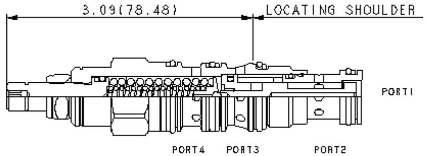
3/2-Wegeventil, direkt betätigt, in Ruhestellung Anschluss 1 mit 2 verbunden und Anschluss 3 verschlossen, für Schaltkreise mit kleinen Volumenströmen. Das Ventil kann den Ölstrom direkt steuern oder als Vorsteuerventil eine Hauptstufe betätigen. Es schaltet, sobald die Druckdifferenz zwischen Anschluss 1 und 4 größer ist als der Einstellwert.
