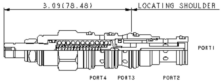
Les distributeurs en cartouches à action directe, à 3 voies (1 vers 2 passant et 3 bloqué) sont des dispositifs de commutation utilisés dans des circuits au débit modéré. Ils peuvent être utilisés tels quels ou pour activer des distributeurs pilotés ou des cartouches logiques de taille supérieure. La valve commute quand la différence de pression entre les chambres 1 et 4 dépasse le tarage.
