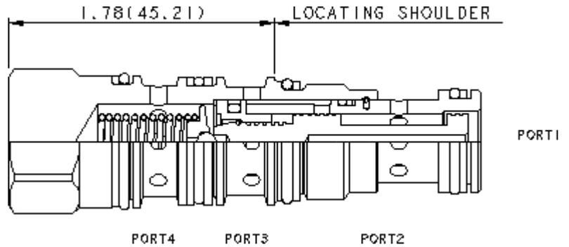
Les distributeurs en cartouches à action directe, à 3 voies (1 vers 2 passant et 3 bloqué) sont des dispositifs de commutation utilisés dans des circuits au débit modéré. Ils peuvent être utilisés tels quels ou pour activer des distributeurs pilotés ou des cartouches logiques de taille supérieure. La valve commute quand la différence de pression entre les chambres 1 et 4 dépasse le tarage.
