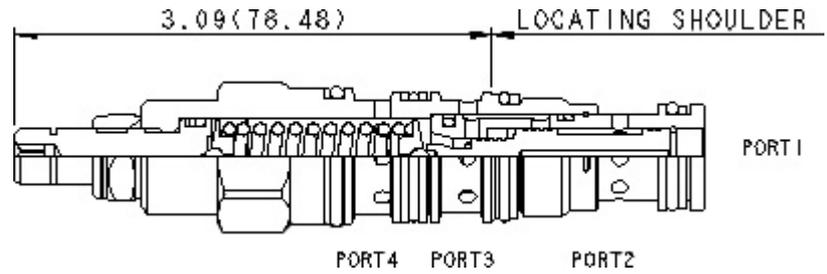
Les distributeurs en cartouches à action directe, à 3 voies (3 vers 4 passant et 2 bloqué) sont des dispositifs de commutation utilisés dans des circuits au débit modéré. Ils peuvent être utilisés tels quels ou pour activer des distributeurs pilotés ou des cartouches logiques de taille supérieure. La valve commute quand la différence de pression entre les chambres 1 et 4 dépasse le tarage.
