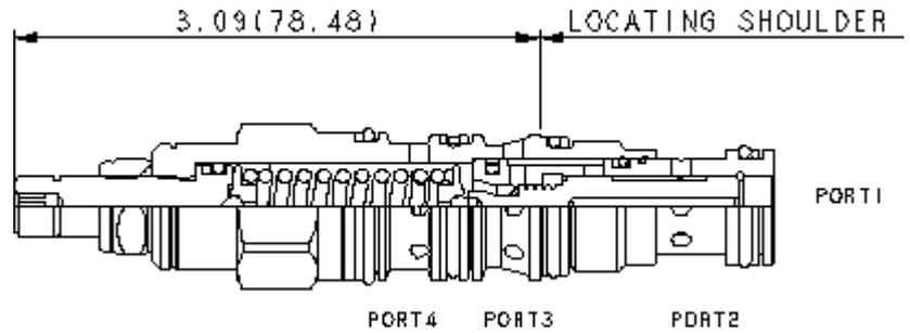
Les distributeurs en cartouches à action directe, à 3 voies (3 vers 4 passant et 2 bloqué) sont des dispositifs de commutation utilisés dans des circuits au débit modéré. Ils peuvent être utilisés tels quels ou pour activer des distributeurs pilotés ou des cartouches logiques de taille supérieure. La valve commute quand la différence de pression entre les chambres 1 et 4 dépasse le tarage.
