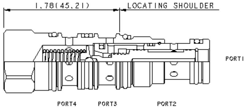
Les distributeurs en cartouches à action directe, à 3 voies (3 vers 4 passant et 2 bloqué) sont des dispositifs de commutation utilisés dans des circuits au débit modéré. Ils peuvent être utilisés tels quels ou pour activer des distributeurs pilotés ou des cartouches logiques de taille supérieure. La valve commute quand la différence de pression entre les chambres 1 et 4 dépasse le tarage.
