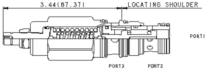
Les distributeurs en cartouches à action directe, à 3 voies (1 bloqué et 2 vers 3 passant) sont des dispositifs de commutation utilisés dans des circuits au débit modéré. Ils peuvent être utilisés tels quels ou pour activer des distributeurs pilotés ou des cartouches logiques de taille supérieure. La valve commute quand la différence de pression entre les chambres 1 et 3 dépasse le tarage.
