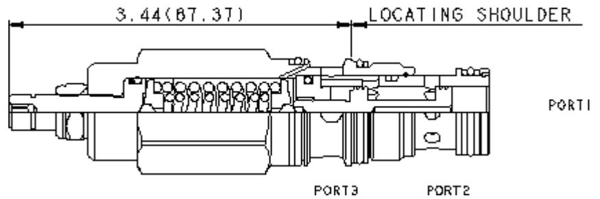
3/2-Wegeventil, direkt betätigt, in Ruhestellung Anschluss 1 verschlossen, Anschluss 2 mit 3 verbunden, für Schaltkreise mit kleinen Volumenströmen. Das Ventil kann den Ölstrom direkt steuern oder als Vorsteuerventil eine Hauptstufe betätigen. Es schaltet, sobald die Druckdifferenz zwischen Anschluss 1 und 3 größer ist als der Einstellwert.
