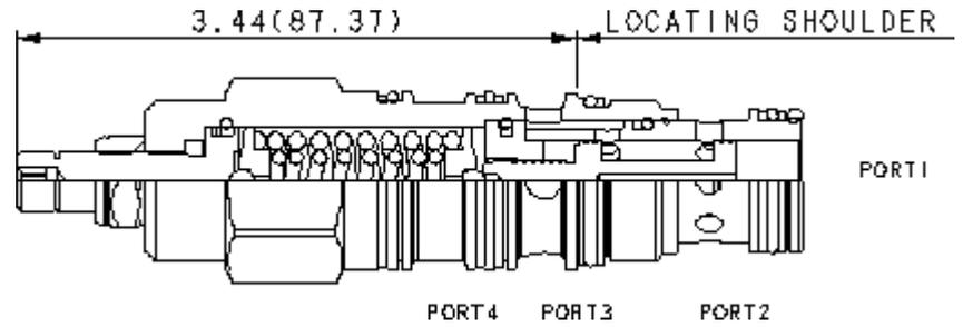
3/2-Wegeventil, direkt betätigt, in Ruhestellung Anschluss 1 verschlossen und Anschluss 2 mit 3 verbunden, für Schaltkreise mit kleinen Volumenströmen. Das Ventil kann den Ölstrom direkt steuern oder als Vorsteuerventil eine Hauptstufe betätigen. Es schaltet, sobald die Druckdifferenz zwischen Anschluss 1 und 4 größer ist als der Einstellwert.
