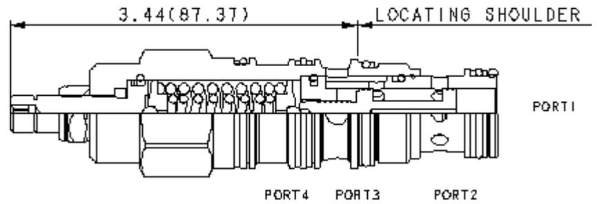
3/2-Wegeventil, direkt betätigt, in Ruhestellung Anschluss 1 verschlossen und Anschluss 2 mit 3 verbunden, für Schaltkreise mit kleinen Volumenströmen. Das Ventil kann den Ölstrom direkt steuern oder als Vorsteuerventil eine Hauptstufe betätigen. Es schaltet, sobald die Druckdifferenz zwischen Anschluss 1 und 4 größer ist als der Einstellwert.
