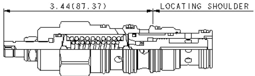
3/2-Wegeventil, direkt betätigt, in Ruhestellung Anschluss 3 mit 4 verbunden und Anschluss 2 verschlossen. Das Ventil kann den Ölstrom direkt steuern oder als Vorsteuerventil eine Hauptstufe betätigen. Es schaltet, sobald die Druckdifferenz zwischen Anschluss 1 und 4 größer ist als der Einstellwert.
